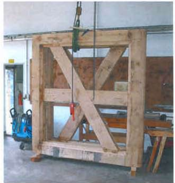
Stemmtorpaar für das Siel im Schöpfwerk Huchting Nord, noch ohne Beplankung
